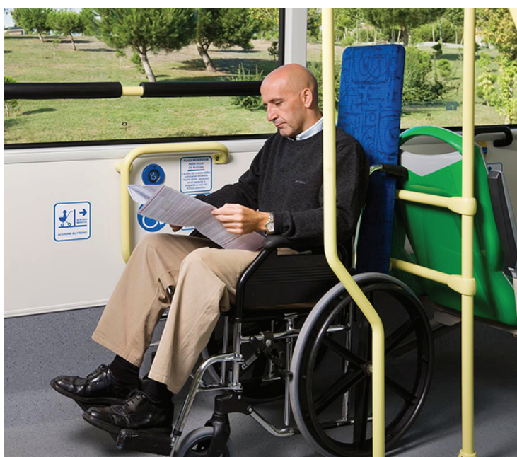
Espacio para silla de ruedas señalizado, con respaldo y cinturón de seguridad.
