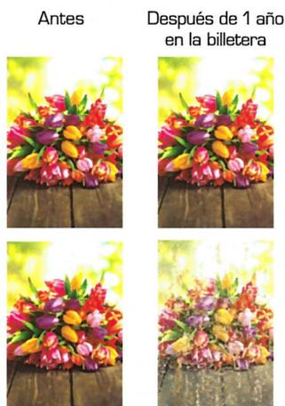
Esta prueba se utiliza para evaluar la integridad de la imagen una vez expuesta a plastificantes.
