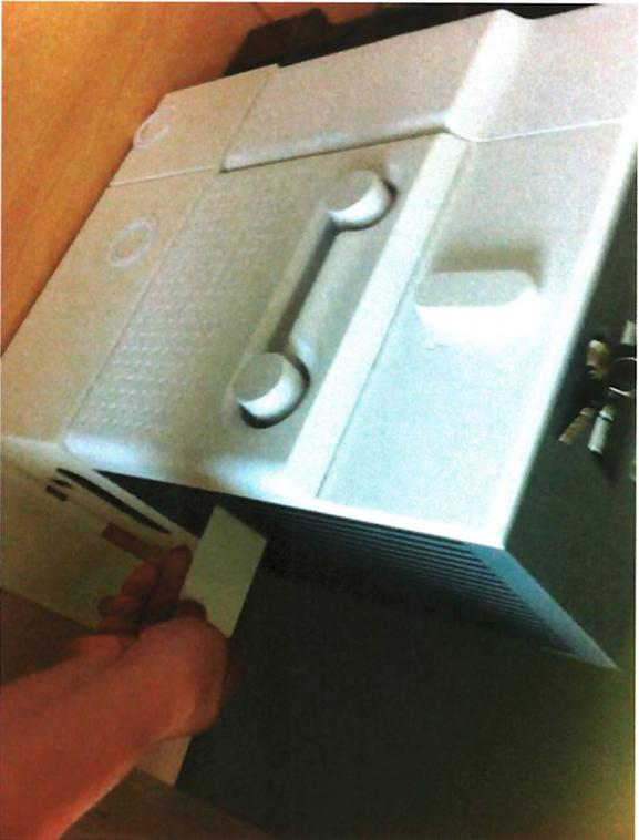
Quando se inserta una tarjeta en la laminadora a través de la entrada de la tarjeta según la imagen, el procedimiento de laminación se inicia automáticamente y la tarjeta se puede laminar
