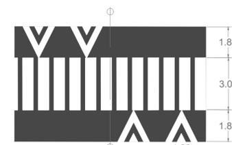
5 Detalle en planta reductor de velocidad (Speed Hump)
