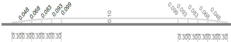
Detalle en sección reductor de velocidad (Speed Table)
